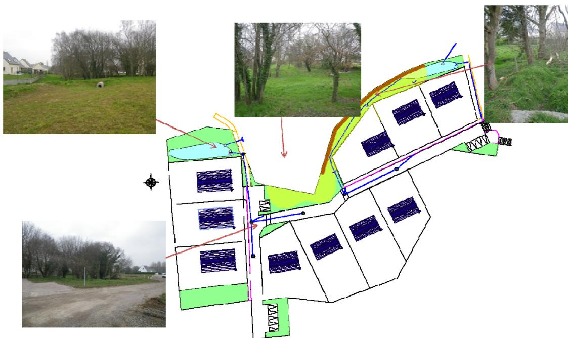
Figure 46 : Projet de lotissement communal des fontaines à la Bouillie : prise en compte des écoulements et zones humides répertoriées, Source : CdC Côte de Penthièvre / Bureau d'Etudes Infraconcept - Rennes
