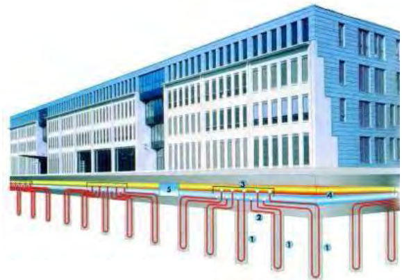
Figure 3 : Pieux géothermiques Source : www.geothermal-energy.ch
