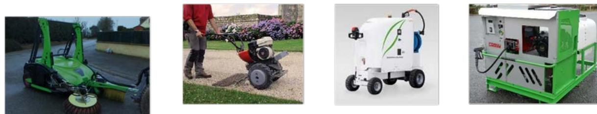
2 modèles de désherbeurs mécaniques motorisés et 2 autres de désherbeurs thermiques à eau chaude (photos LTM)
