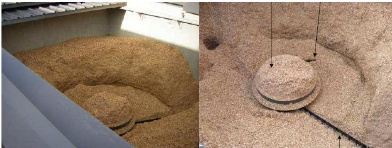
4 Illustration d'un silo avec pale rotative associée à une vis sans fin
