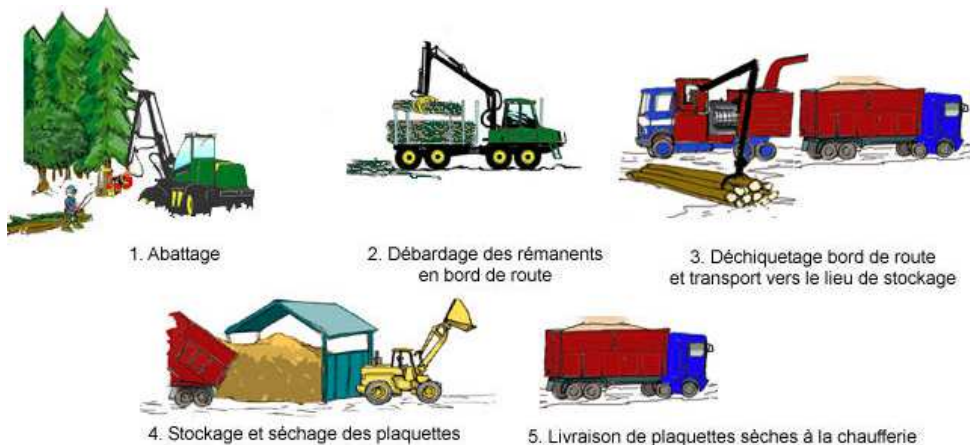
Figure 2 : Production de plaquettes forestières bord de route et transport sur le lieu de stockage (source ITEBE)
